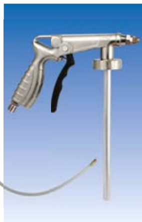
Пистолет за обработка на кухни Метален. Широк отвор за вакса, със сонда 600 мм и 360° дюза. Работно налягане 3.5-4.5 бара вакса и 3-4 бара Фертан № 8011504
